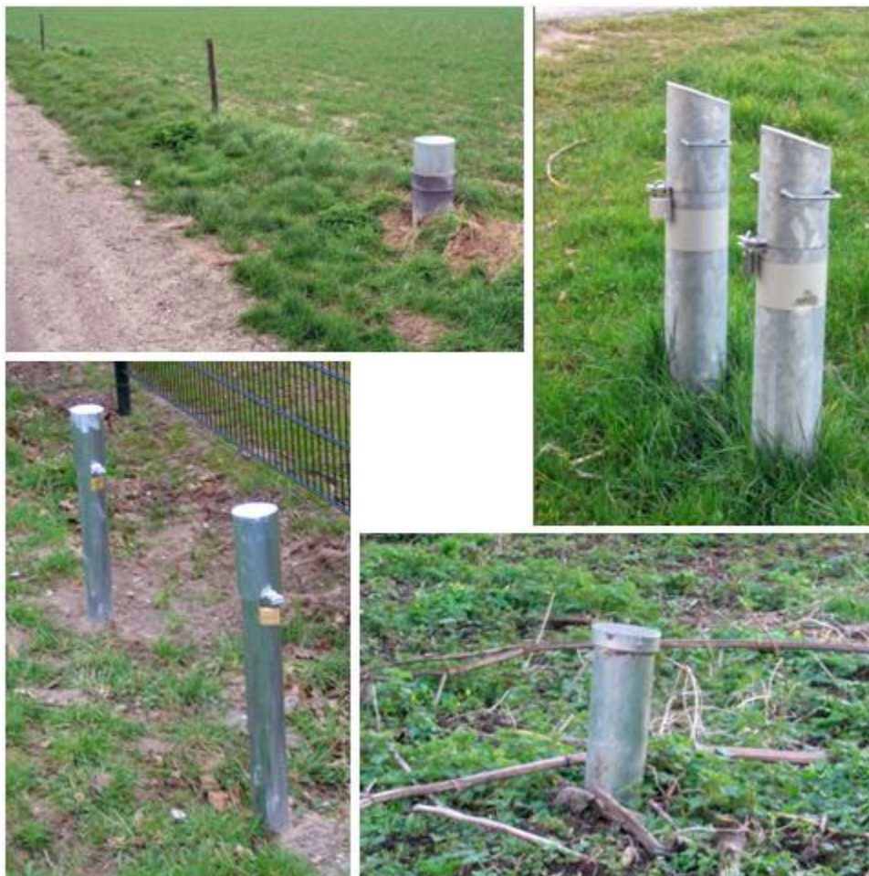
Figuur 5.2 Peilbuisbescherming. Linksboven: robuuste bescherming, redelijk ruime afstand tot wegrand. Rechtsboven: robuuste bescherming (ondanks beschadiging door maaien). Linksonder: lichte (smalle) beschermbuis, anti-maaipalen kunnen betere bescherming geven. Rechtsonder: lichte bescherming, bij onderhoudswerkzaamheden beschadigd. Beschermkap vervangen. Bij vervanging peilbuis locatiekeuze aanpassen.
